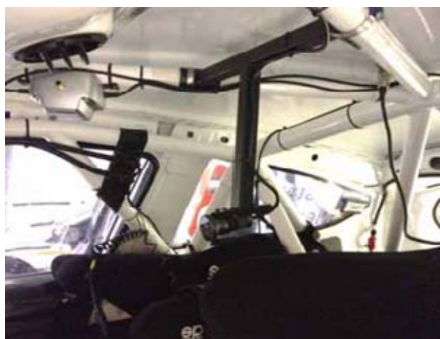
Na obrázku je nepovolená instalace interní kamery – nebezpečný držák
